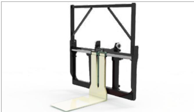
Tablier à broche avec positionnement des fourches simultané et indépendant (pour applications de manutention de bois d'œuvre).
